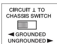
Mit dem Groundlift-Schalter können Sie Brummschleifen verhindern. Wenn die Endstufe zusammen mit anderen Geräten in einem 19"-Rack betrieben wird, sollte der Schalter in Stellung GROUNDED stehen. Wird die Endstufe mit Geräten mit unterschiedlichem Erdungspotenzial betrieben, sollte der Schalter in Stellung UNGROUNDED stehen.
